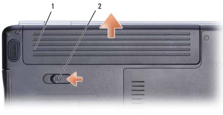
1 batterie      2 loquet de fermeture de batterie
