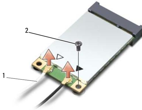
1 connecteurs de câble d'antenne      2 vis de fixation
