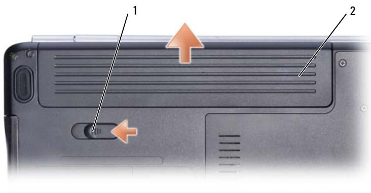
1 loquet de fermeture de batterie      2 batterie
