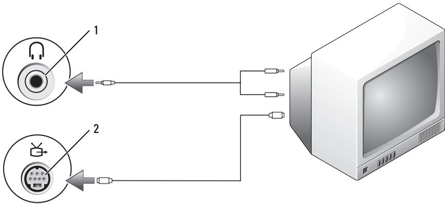
1 connecteur audio      2 connecteur de sortie TV S-vidéo
